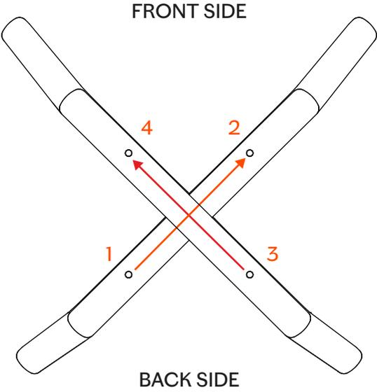
Avvitare la base seguendo l'ordine dei numeri illustrati, per garantire maggior precisione nel montaggio. | Screw the wooden base, following the illustrated order, to ensure a higher precision.
