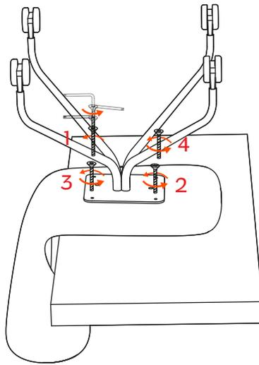
Posizionare la base da ufficio della sedia capovolta sopra la seduta ed avvitare i due componenti con le viti in dotazione. | Put the chair swivel base on castors on the shell layed previously upside-down and screw the two elements with the given screws.
