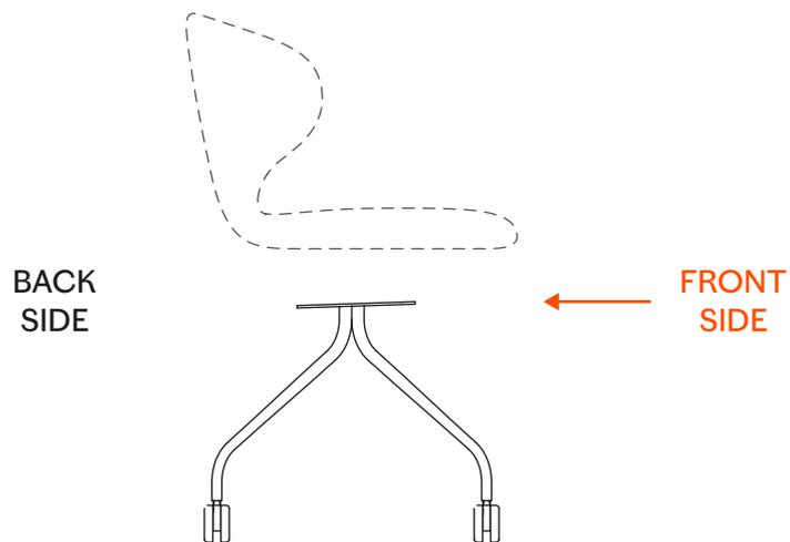
ATTENZIONE! La parte frontale della base su ruote è quella **più alta**, come da immagine. | WARNING! The front-side of the swivel 4-star base on castors is the **higher** one, as shown in the picture.
