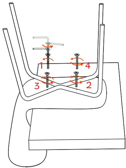
Posizionare la struttura della sedia capovolta sopra la seduta ed avvitare i due componenti con le viti fornite. | Put the chair metal base on the shell layed previously upside-down and screw the two elements with the given screws.
