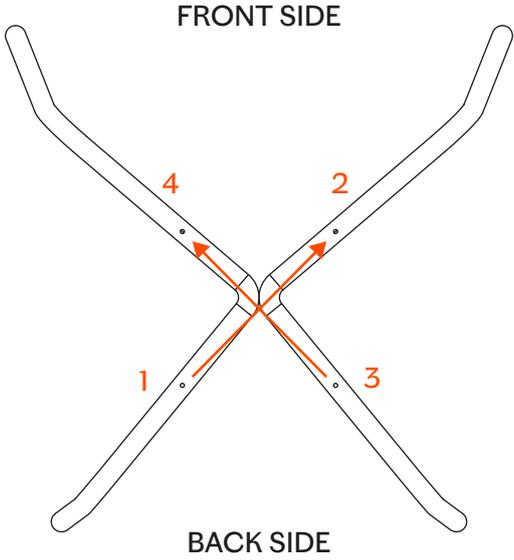
Avvitare la base seguendo l'ordine dei numeri illustrati, per garantire maggior precisione nel montaggio. | Screw the metal base, following the illustrated order, to ensure a higher precision.
