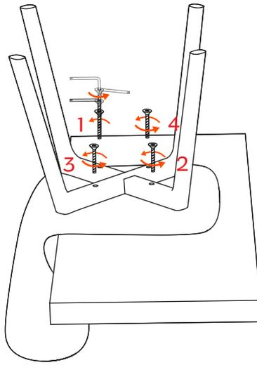
Posizionare la struttura della sedia capovolta sopra la seduta ed avvitare i due componenti con le viti fornite. | Put the chair wooden base on the shell layed previously upside-down and screw the two elements with the given screws.
